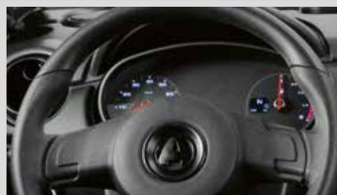
Kombiinstrument mit Tacho- & Tankanzeige analog und einem digitalen Anzeigenfeld rechts
