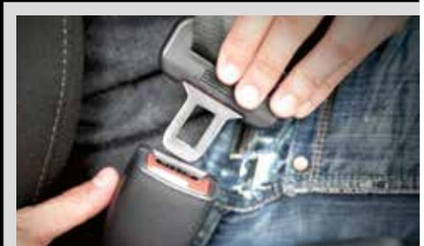
Die Sicherheitsgurte werden unter Vollast bei einer Zugbelastung von 5,4 Tonnen (doppelt so viel wie die Gesetzgebung mit 2,7 Tonnen vorschreibt) getestet. Sie verhindern zudem das Blockieren im Falle eines Unfalls.
